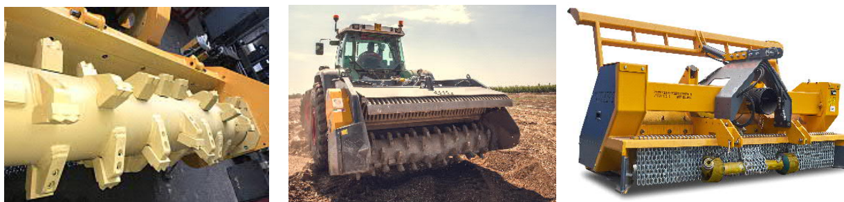
Рисунок 3 – Общий вид роторов и их рабочих органов для дробления и измельчения камней в почве, на валках, насыпях и гарригах
