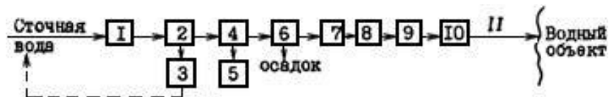
Рис. 6.2.1. Схема очистных сооружений с биофильтрами:
